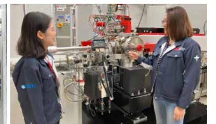
高質量分解能・高空間分解能二次イオン質量分析計(NanoSIMS)
