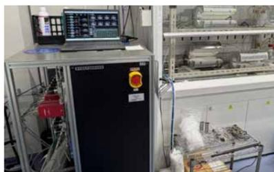
自動制御型雰囲気炉
