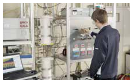
NH 3 とCO 2 から合成ガスを製造するポンププラント
